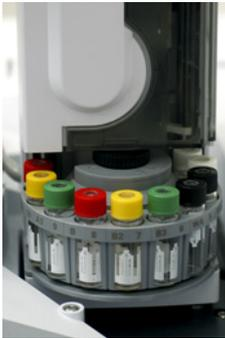
Bei Autosamplern, die mit einer Spritze die Probe aus dem Autosampler-Vial entnehmen und dann injizieren, muss die Spritze nach jeder Injektion gespült werden, um die Verschleppung von einer Probe auf die nächste zu minimieren. Mit steigender Empfindlichkeit der Analyse wird dieser Reinigungsschritt immer wichtiger, besonders, wenn verschiedene oder viskose Proben gemessen werden. Die Flaschen, in denen das Lösungsmittel für die Spülung bereitgestellt wird, sind die sogenannten Waschvials.
